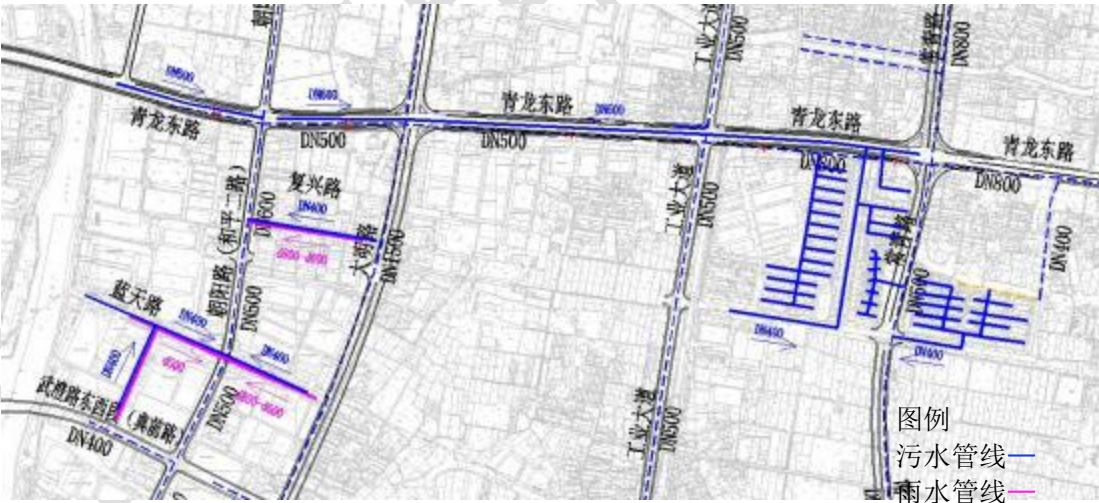
图 2-9 和平工业园及周边污水管网方案图
