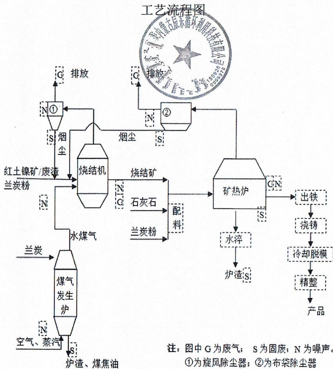
生产工艺流程及产污环节图
