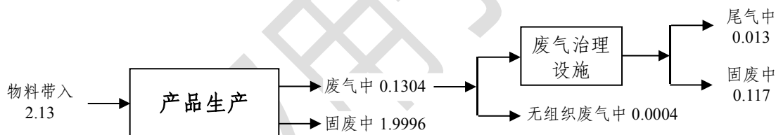
图 3.3-44 乙酸乙酯特征因子平衡图 (t/a)
